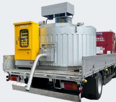
高粘度系アスファルト溶解装置
